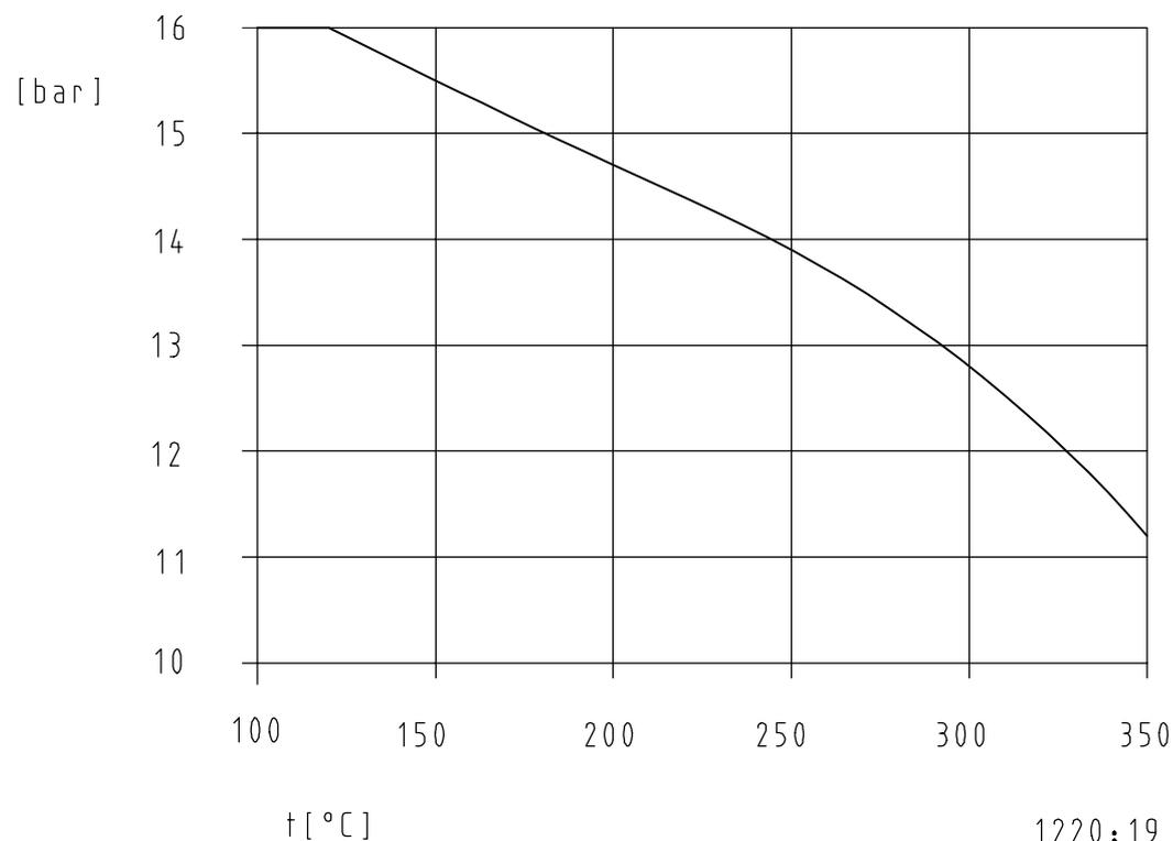
Зависимость Давление-Температура для фланцев согласно EN 1092-2
